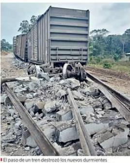
El paso de un tren destruyó los nuevos durmientes que son colocados en la vía del Istmo de Tehuantepec.
